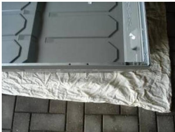
Der ABS-Deckel wird wieder auf den Anhänger drauf gesetzt, und die Montage der Seitenteile kann beginnen.
