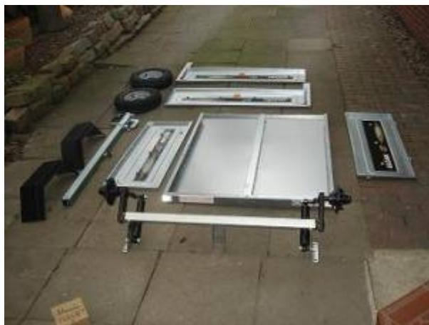
Auch die Montage gestaltete sich recht einfach, trotz einer französischen Bauanleitung. Nach ca. 2 Stunden Gesamtzeit war der Daxara 127 aufgebaut und das Hardtop montiert. Die Schlosser versagten leider sehr schnell den Dienst. Hier wurde scheinbar vergessen diese wenigstens einmal im Werk einzuölen. Ein bisschen Kriechöl sorgte jedoch schnell wieder für einwandfreie Funktion. Somit war der Daxara 127 vollständig und betriebsbereit.
