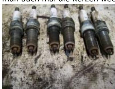
PS: Zylinder 1 (ganz rechts) hatte das defekte Zündkabel.
