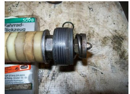
Alle anderen Dämpfer haben eher was Gummiartiges. Damit das mit dem PTFE in den KW Dämpfern funktioniert ist die „Packung“ der Kolben mehrschichtig aufgebaut und somit viel dicker. Es sind aber alles
