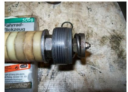
Alle anderen Dämpfer haben eher was Gummiartiges. Damit das mit dem PTFE in den KW Dämpfern funktioniert ist die „Packung“ der Kolben mehrschichtig aufgebaut und somit viel dicker. Es sind aber alles
