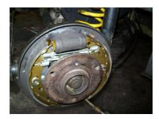
Die Bremse (incl. Handbremse) grob vor ein zu stellen rein setzen, die Bremse voll treten und langsam aber kräftig die Handbremse öfter ziehen. Der Nachsteller verdreht sich bei jedem ziehen und beseitigt so das unnötige Spiel.
