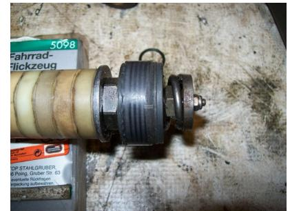
Alle anderen Dämpfer haben eher was Gummiartiges. Damit das mit dem PTFE in den KW Dämpfern funktioniert ist die „Packung“ der Kolben mehrschichtig aufgebaut und somit viel dicker. Es sind aber alles
