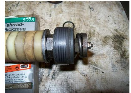
Alle anderen Dämpfer haben eher was Gummiartiges. Damit das mit dem PTFE in den KW Dämpfern funktioniert ist die „Packung“ der Kolben mehrschichtig aufgebaut und somit viel dicker. Es sind aber alles
