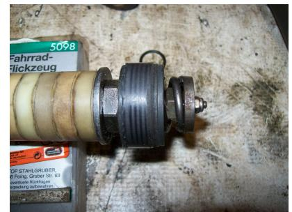
Alle anderen Dämpfer haben eher was Gummiartiges. Damit das mit dem PTFE in den KW Dämpfern funktioniert ist die „Packung“ der Kolben mehrschichtig aufgebaut und somit viel dicker. Es sind aber alles Zweirohrdämpfer wobei bei KW kein Gasdruck gebraucht wird.
