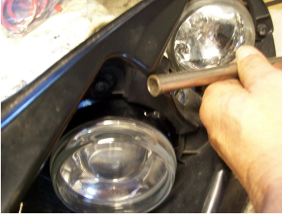
3. Löcher auf 14mm auf bohren
