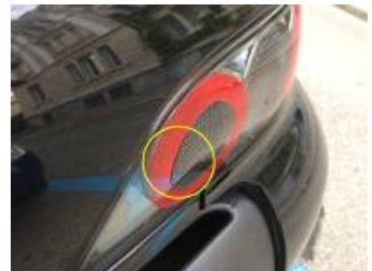
Bei eingelegtem Rückwärtsgang wird der Rückfahrscheinwerfer extrem heiß. Dies kann zu Beschädigungen des Lampengehäuses führen.
