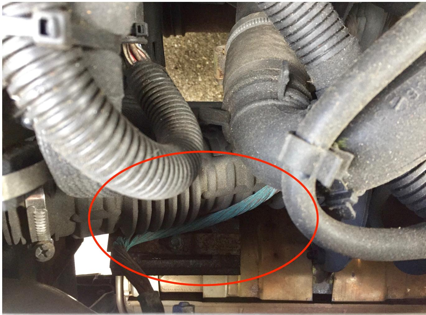
Im Motorraum links hinten verbindet ein Massekabel Motor (von Auspuffhalterung am Getriebe auf Seite der linken Antriebwelle) und Karosserie. Dieses Massekabel besteht aus gedrehten Kupferleitungen und ist im Original nicht isoliert, was zu Korrosion führt. Die Folge sind unzählige Probleme, die durch den Tausch des Kabels gegen eine isolierte Version (Teilenummer Q 0003105V005000000) behoben werden können.
