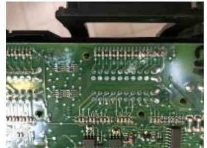
Defektes SAM (Signalerfassungs- und Ansteuerungsmodul). Wasser dringt in das Innere ein (vornehmlich über die Anschlüsse N11-8 und N11-9) und zerstört dort Lötstellen, Leiterbahnen und Bauteile. Dieser Vorgang kann sich über Jahre abspielen bevor es zu merkbaren Defekten kommt.
