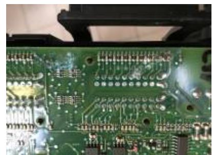
Defektes SAM (Signalerfassungs- und Ansteuerungsmodul). Wasser dringt in das Innere ein (vornehmlich über die Anschlüsse N11-8 und N11-9) und zerstört dort Lötstellen, Leiterbahnen und Bauteile. Dieser Vorgang kann sich über Jahre abspielen bevor es zu merkbaren Defekten kommt.
