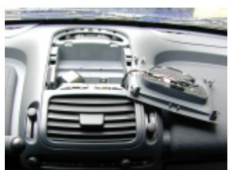
Die Zusatzinstrumente einrasten und mit den zuvor entfernten Schrauben wieder anschrauben. Das Anschlusskabel nach unten in Richtung Radioschacht durchführen.
