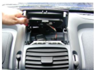
Mit einem Torx 10 die zwei Befestigungsschrauben vorne lösen und die Abdeckung entfernen.
