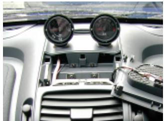
Sicherheitsinsel wieder einrasten. Zierringe an den Zusatzinstrumenten anbringen (nur in einer Richtung möglich). Der Stecker für den Anschluss des Zusatzinstrumentenkabels ist meist durch den Radioschacht zu erreichen. Sollte dies nicht der Fall sein, ist der Ausbau der Mittelkonsole notwendig.
