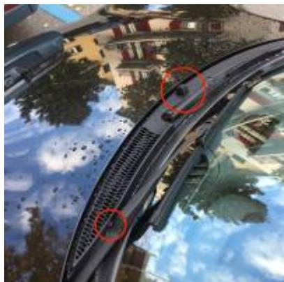
Nadel in Düsenöffnung einführen und Düse ausrichten. Die Wischerdüse ist richtig ausgerichtet, wenn der Wasserstrahl mittig auf die Scheibe trifft.
