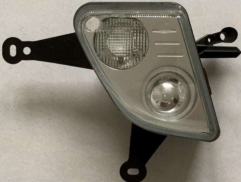
Grundsätzlich gibt es die Lampengehäuse vorne mit und ohne Öffnung für Nebelscheinwerfer. Bis 2004 wurde jedoch auch ein Lampengehäuse verbaut, bei dem die Standlichtbirne mittig angebracht war. Ab 2004 befindet sich die Aussparung für die Standlichtbirne oben.
