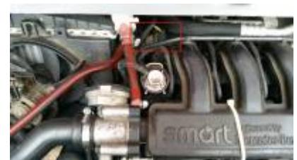
Zu Beginn muss das Kühlsystem druckentlastet werden. Dazu wird der Ausgleichsbehälter der Kühlflüssigkeit kurz komplett geöffnet und anschließend wieder verschlossen.
