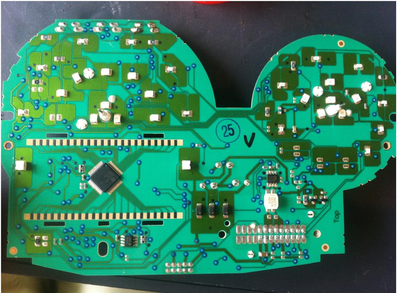
Bei der Platine des Kombiinstrumentes handelt es sich um eine Double-Layer Platine mit Durchkontaktierungen und Voll-SMT-Bestückung, mit Ausnahme der drei Elkos und der Buchse. Sie hat die ungefähren Maße von 120x190mm und eine Dicke von ca. 1,6mm. Die Form erinnert an einen Dreiviertelkreis, einen Halbkreis und ein Rechteck. Es sind außerdem über die Platine verteilt Testpads aus Graphit vorzufinden, die vermutlich an wichtige Leitungen angebunden sind.
