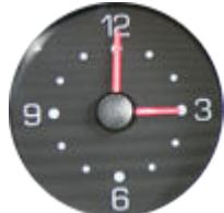
Die Uhr hat eine Schwachstelle und das sind die Lötstellen im Inneren, diese lösen sich gerne durch die Vibrationen beim Fahren. Dies verursacht falsch, gar nicht oder rückwärts gehende Uhren.
