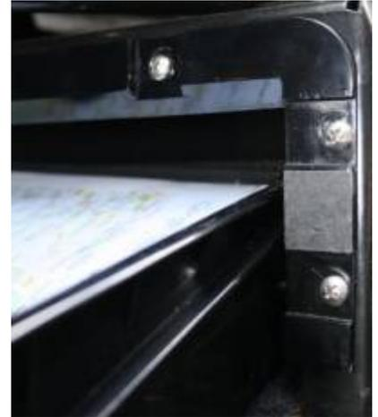
Die Einfachste Montage ist, die schrauben vorher ohne Schublade in die Löcher zu schrauben, um ein passendes Gewinde zu schneiden.
