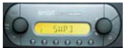
Das Radio Verfügt laut Herstellerangaben über eine Ausgangsleitung von 2 x 21 Watt.
