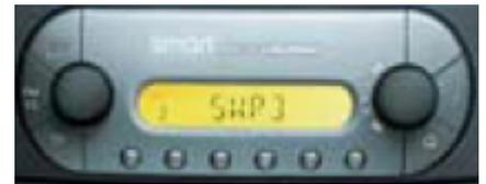
Das Radio verfügt laut Herstellerangaben über eine Ausgangsleistung von 2 x 21 Watt.
