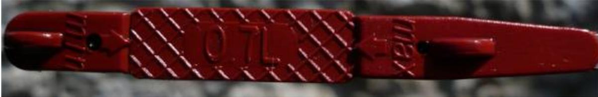
Der Ölstand sollte zwischen Min (links) und der Max (rechts) liegen. Wie auf dem Bild zu erkennen liegen zwischen der Min und der Max Markierung 0,7 Liter.
