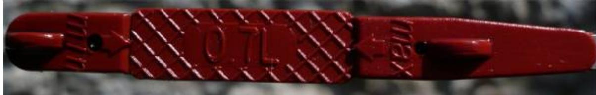
Der Ölstand sollte zwischen Min (links) und der Max (rechts) liegen. Wie auf dem Bild zu erkennen liegen zwischen der Min und der Max Markierung 0,7 Liter.
