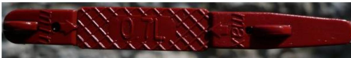
Der Ölstand sollte zwischen Min (links) und der Max (rechts) liegen. Wie auf dem Bild zu erkennen liegen zwischen der Min und der Max Markierung 0,7 Liter. Da der Motor schräg eingebaut ist, sollte die hintere Markierung berücksichtigt werden. Wenn der Ölstand auf der vorderen Markierung Max erreicht, ist der Ölstand schon zu hoch - Gefahr Motorschaden.
