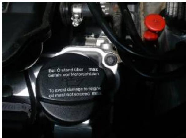
Zur Messung sollte der Motor warmgefahren werden (3 Eier im Display / Temperaturanzeige) und auf einem ebenen Untergrund geparkt werden.
