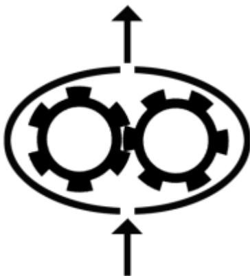
Die beiden ineinandergreifenden Zahnräder fördern das Öl an der äußeren Wannenseite nach oben, die Verzahnung in der Mitte verhindert das zurücklaufen des Öls.
