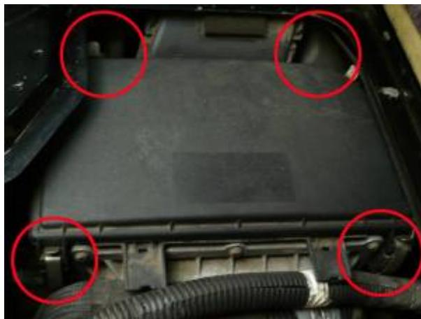
Beim Lösen der Klammern sollte man darauf achten, dass diese sich nicht aushaken und in den Motorraum fallen.
