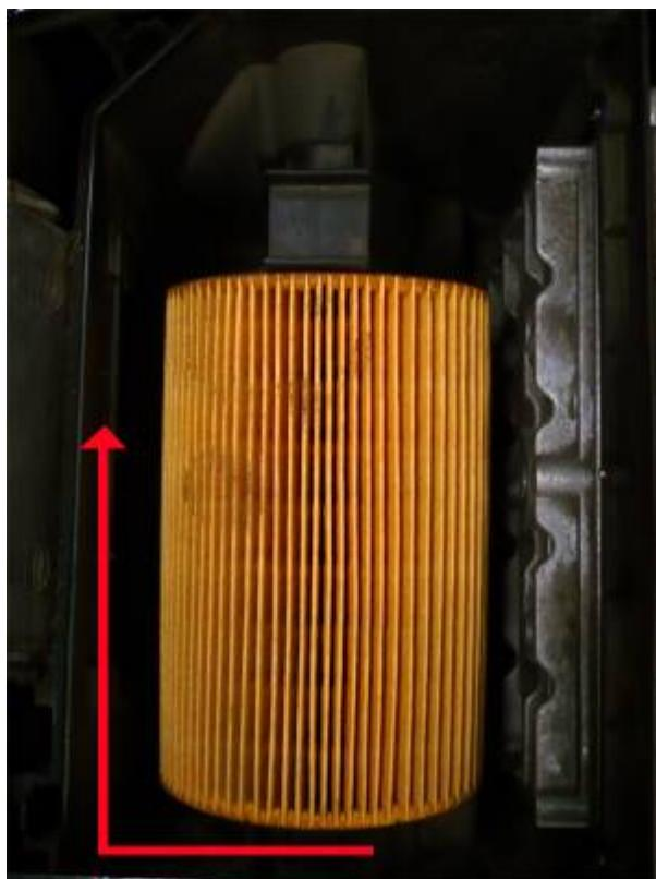
Nach einsetzen des neuen Filters muss das Rohr auf der Seite des Ansaugtraktes wieder in den Filter gedrückt werden.
