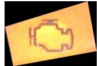
Leuchtet die Kontrollleuchte dauerhaft so arbeitet die Motorelektronik nicht fehlerfrei.
