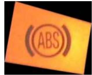
Leuchtet die Kontrolleuchte Dauerhaft ist das ABS gestört (ABS-Notlauf).
