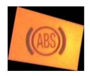
Leuchtet die Kontrolleuchte Dauerhaft ist das ABS gestört (ABS-Notlauf).
