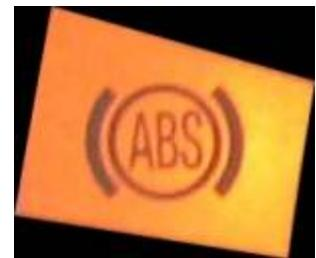
Leuchtet die Kontrollleuchte Dauerhaft ist das ABS gestört (ABS-Notlauf).
