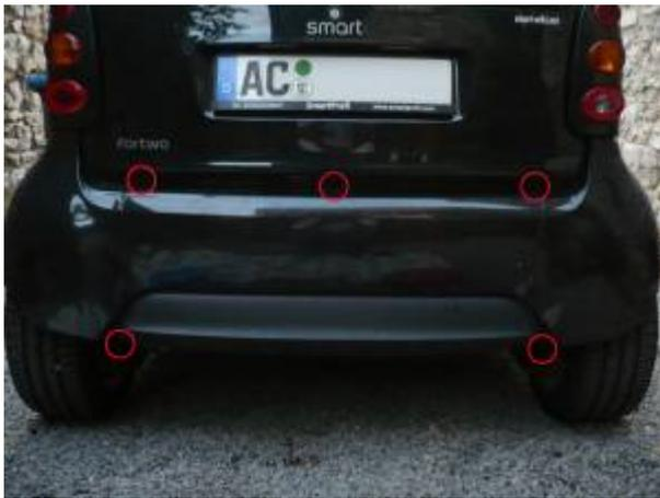
Nun können die oberen Schrauben gelöst werden. Die mittlere Schraube sollte vorerst zur Stabilisierung nicht ganz herausgedreht werden.
