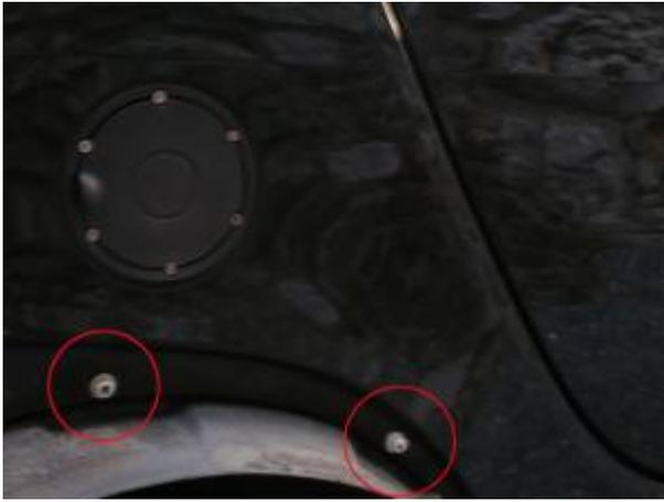
Diese lösen sich durch leichtes Ruckeln und nach hinten Ziehen des Panels aus ihrer Nut.
