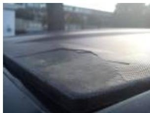
Defektes Plastikdach eines Pure
