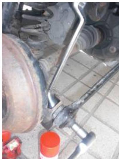
Um die Schrauben (Aussenseite) wieder montiert zu bekommen empfieilt sich, den Smart mit allen vier Rädern auf den Boden zu stellen und eins der beiden Achsrohre mit dem Wagenheber anzuheben(wenn die Schraube sich nicht einstecken lässt). Es werden teilweise Spanngurte als Hilfsmittel empfohlen, habe ich noch nicht ausprobiert.
