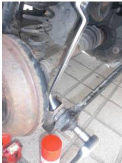
Um die Schrauben (Aussenseite) wieder montiert zu bekommen muss, der Smart mit allen vier Rädern auf den Boden stehen dann lassen sich die Befestigungsschrauben einstecken. Der Anzug der Schrauben darf ebenfalls nur vorgenommen werden wenn das Auto auf dem Boden steht.
