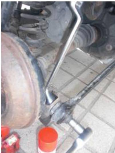
Um die Schrauben (Aussenseite) wieder montiert zu bekommen muss, der Smart mit allen vier Rädern auf den Boden stehen dann lassen sich die Bedestigungsschrauben einstecken. Der Anzug der Schrauben darf ebenfalls nur vorgenommen werden wenn das Auto auf dem Boden steht.
