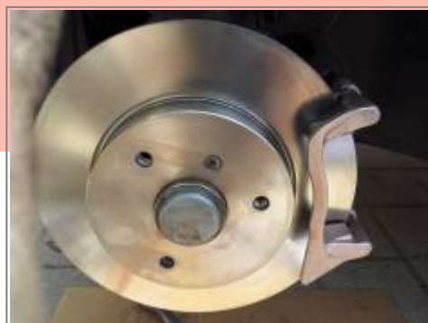
Erneuern der vorderen Bremsanlage
