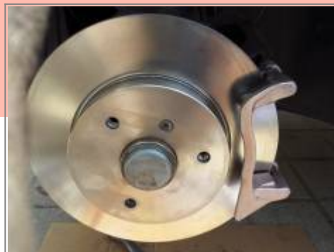
Erneuern der vorderen Bremsanlage
