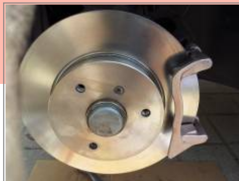
Erneuern der vorderen Bremsanlage
