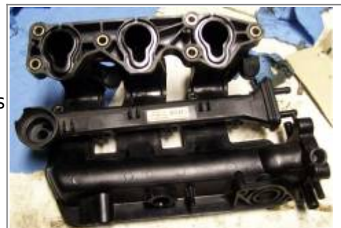
Erneuern der Ventildeckeldichtung
