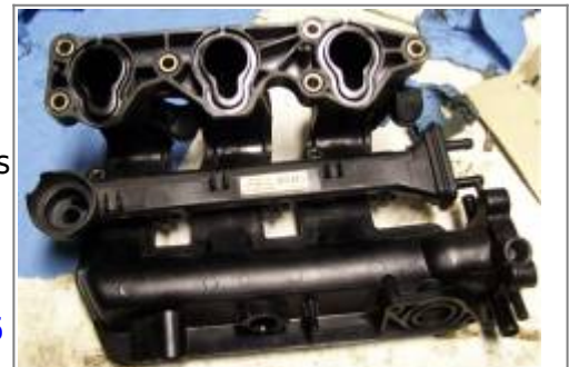
Erneuern der Ventildeckeldichtung
