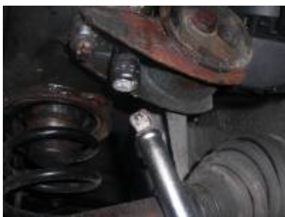
linkes Motorlager (Fahrerseite; zwei Schrauben mit E14)
