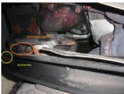
rechtes Motorlager und Querstrebe; zwei Schrauben mit E14 für das Lager
