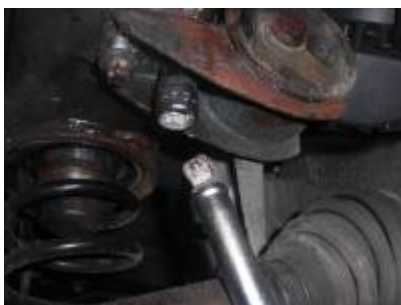
linkes Motorlager (Fahrerseite; zwei Schrauben mit E14)
