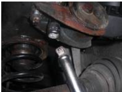
linkes Motorlager (Fahrerseite; zwei E14 Schrauben)
