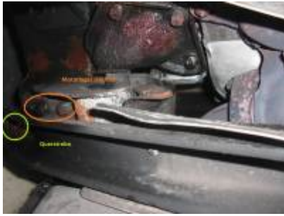
rechtes Motorlager (14 Schrauben) und Querstrebe
