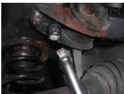
linkes Motorlager (Fahrerseite; zwei E14 Schrauben)
