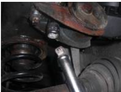
linkes Motorlager (Fahrerseite; zwei E14 Schrauben)
