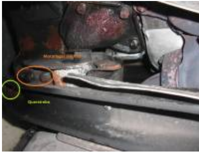
rechtes Motorlager (14 Schrauben) und Querstrebe
