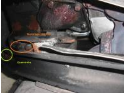
rechtes Motorlager (14 Schrauben) und Querstrebe
