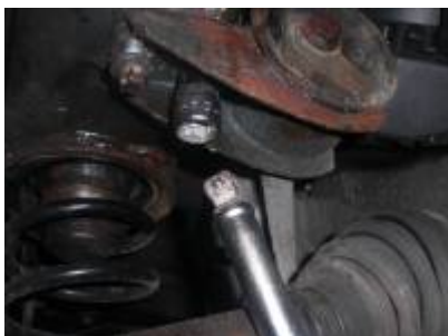
linkes Motorlager (Fahrerseite; zwei E14 Schrauben)
