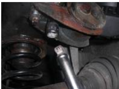
linkes Motorlager (Fahrerseite; zwei E14 Schrauben)
