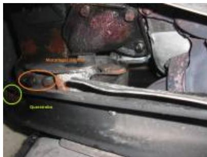
rechtes Motorlager (14 Schrauben) und Querstrebe
