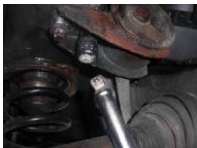
linkes Motorlager (Fahrerseite; zwei E14 Schrauben)
