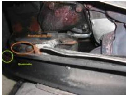
rechtes Motorlager (14 Schrauben) und Querstrebe
