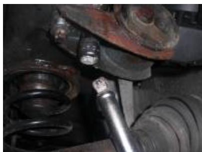
linkes Motorlager (Fahrerseite; zwei E14 Schrauben)
