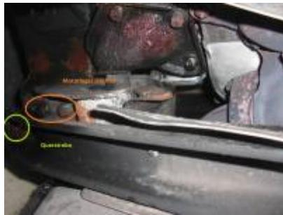
rechtes Motorlager (14 Schrauben) und Querstrebe
